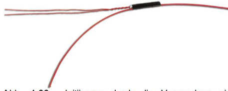
Abb. 4-36 Initiiierung durch die Verwendung eines elektrischen Zünders
